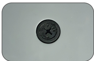
Le porte-fusible se trouve sur le n'est dessous de l'appareil.
